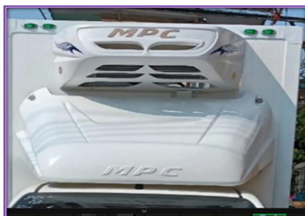
รูปที่ 4.14 คอนเดนเซอร์ ( Condenser) ชุดทำอุณหภูมิความเย็นรถขนส่งสินค้าแบบควบคุมอุณหภูมิ
